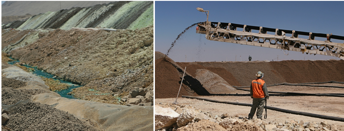
Abbildung 62: links: Auffanggraben der kupferhaltige Lösung aus der Haldenlaugung; rechts: Vorbereitung einer Halde zur mikrobiologisch unterstützten sauren Laugung kupferreicher Erze (Kupferbergwerk El Salvador der Codelco in Chile).
