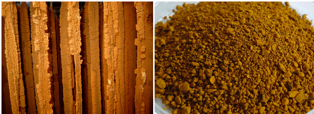
Abbildung 42: Schwertmannit auf Aufwuchselementen (links, Bildbreite ca. 1 m) und Mikrobiell hergestellter Schwertmannit (rechts, Bildbreite etwa 15 cm; Fotos: Eberhard Janneck).
