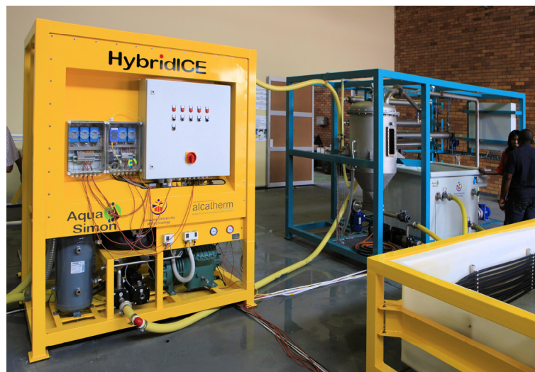
Abbildung 47: Wasserreinigungsanlage zur eutektischen Gefrierkristallisation auf dem Soshanguve Campus der Technischen Universität Pretoria (Tshwane University of Technology; HybridICE-Verfahren).
