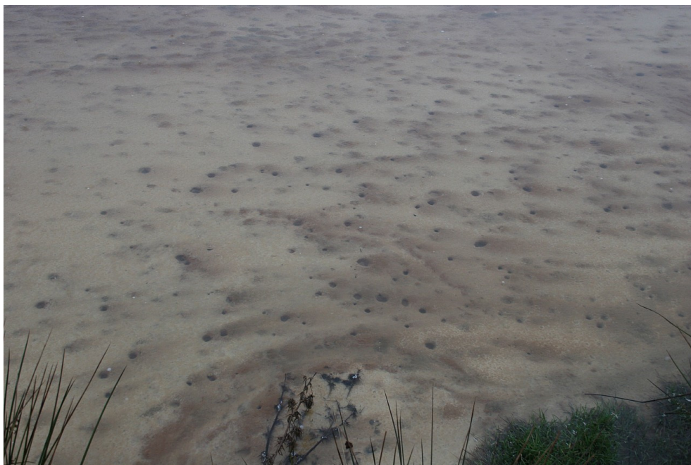
Abbildung 55: Durch Gasaustritt hervorgerufene Kanäle auf der Oberfläche des organischen Substrats im RAPS Bowden Close, Landkreis Durham, England. Durchmesser der Kanäle im Zentimeterbereich; Bildbreite in der Mitte etwa 3 m.
