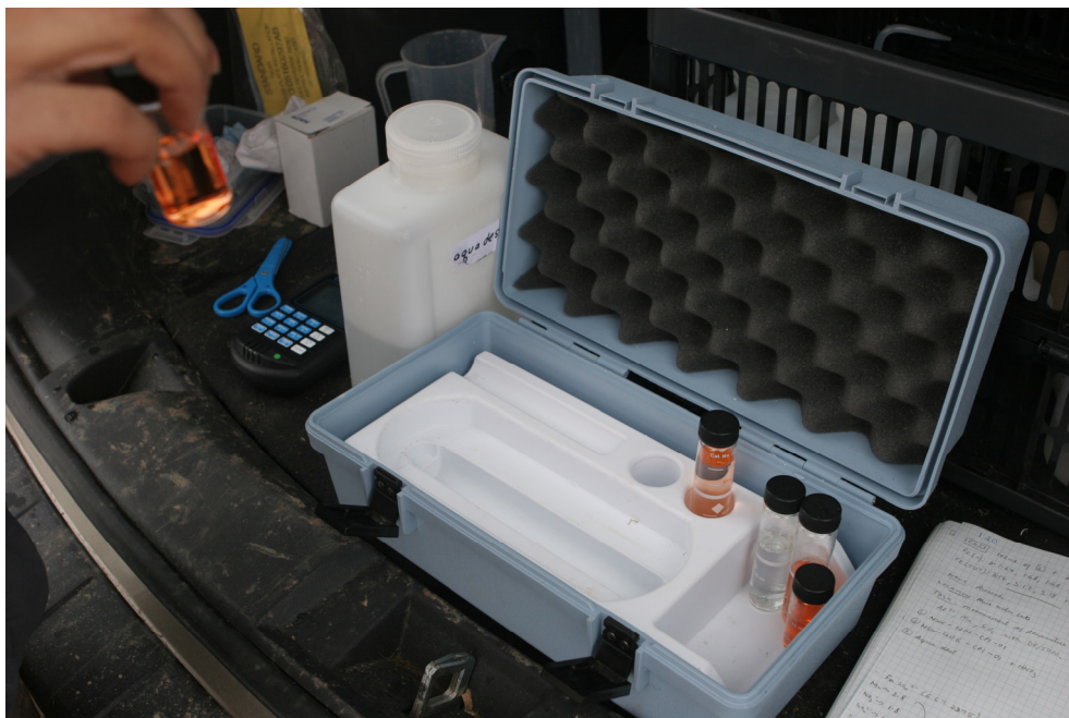
Abbildung 18: Photometrische vor-Ort-Analyse von Gesamteisen und \text{Fe}^{2+} .
