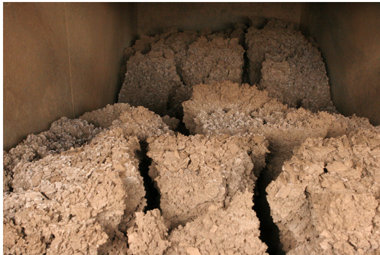
Abbildung 31: Durch Filterpressen entwässerter Schlamm (Sauerwasserreinigungsanlage Flughafen Halifax, Neuschottland, Kanada; Bildbreite ca. 1 m).
