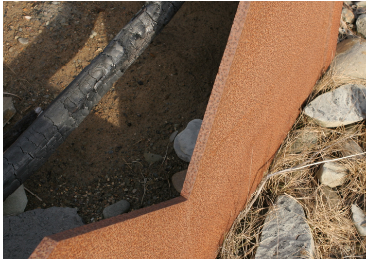
Abbildung 16: Falsch konstruiertes Messwehr für einen Grubenwasseraustritt des 1B Mine Pools auf der Cape Breton Insel, Neuschottland, Kanada. Die Wehrplatte ist zu dick (2 cm), besteht aus nicht rostfreiem Material und es fehlt die abgeschrägte, wasserseitige Abrisskante. Das Messwehr war über einen Zeitraum von ca. 1 Jahr im Einsatz um Durchflüsse mit „hoher Genauigkeit“ zu messen.
