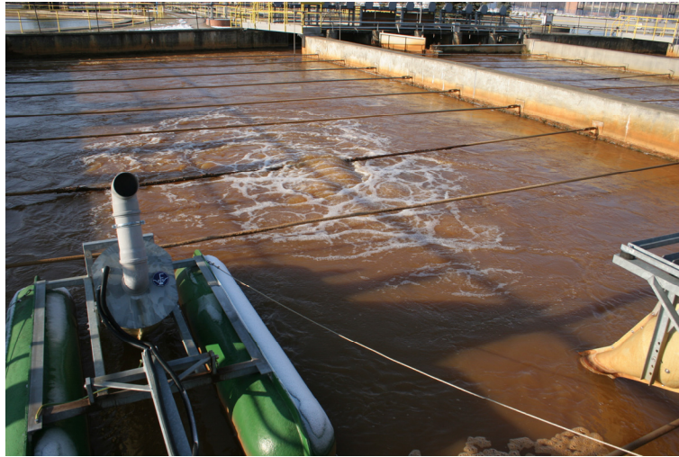
Abbildung 30: Belüftung von Grubenwasser in einer Dünnschlammanlage (Grubenwasserreinigungsanlage „Schwarze Pumpe“, Lausitz).
