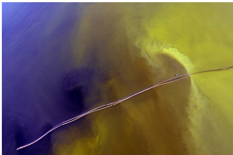
Abbildung 65: Einspülen von gelöschtem Kalk in den Scheibensee im November 2010 über Schlauchleitungen und eine landgestützte Zugabestation (Bildbreite etwa 500 m; Foto: Peter Radke, LMBV).
