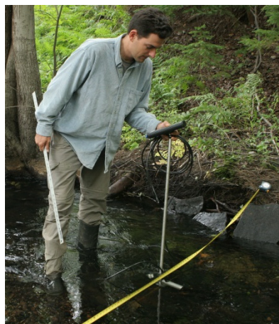
Abbildung 9: Durchflussmessung mit einem akustisch-digitalen Strömungsmessgerät in einem durch Grubenwasser beeinflussten Bach (Cape Breton Insel, Neuschottland, Kanada). Der Bearbeiter steht korrekt abstromig des Messgeräts und hält das Gerät weit weg vom Körper, um den Durchfluss möglichst nicht zu beeinträchtigen.
