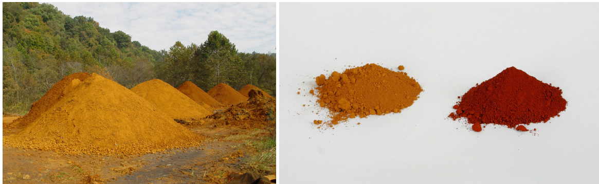
Abbildung 71: Halden mit Ocker aus einer passiven Grubenwasserreinigung nach dem Entwässern und Trocknen (links) und getrockneter sowie gebrannter Ocker (rechts; Fotos: Bob Hedin).
